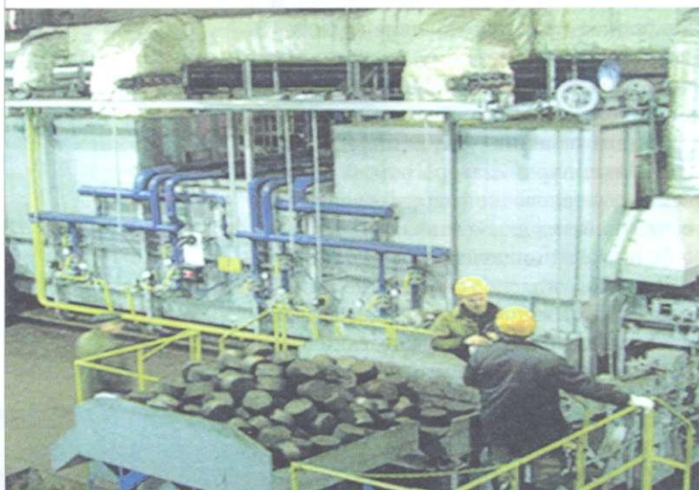
Установка горячего брикетирования металлической стружки
