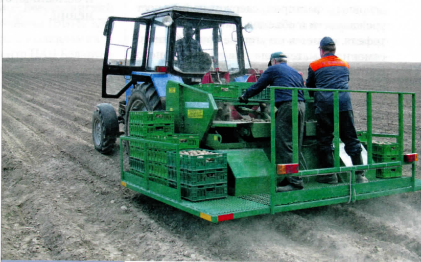
Приемочные испытания сажалки пророщенного картофеля КСП-2 (Белорусская МИС)
