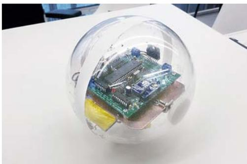
— Он основан на использовании параллельного манипулятора внутри самого робота, — вдается в технические подробности Григорий Прокопович. — Параллельный манипулятор состоит из радиально расположенных звеньев, соединенных шарнирами с внутренней поверхностью корпуса и рабочим органом. В последнем расположены все жизненно важные функции робота: от блоков питания до блоков системы управления. Благодаря всенаправленному
