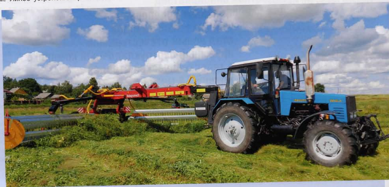
Грабли-валкователи гребенчатого типа с шириной захвата 9,5 метра
