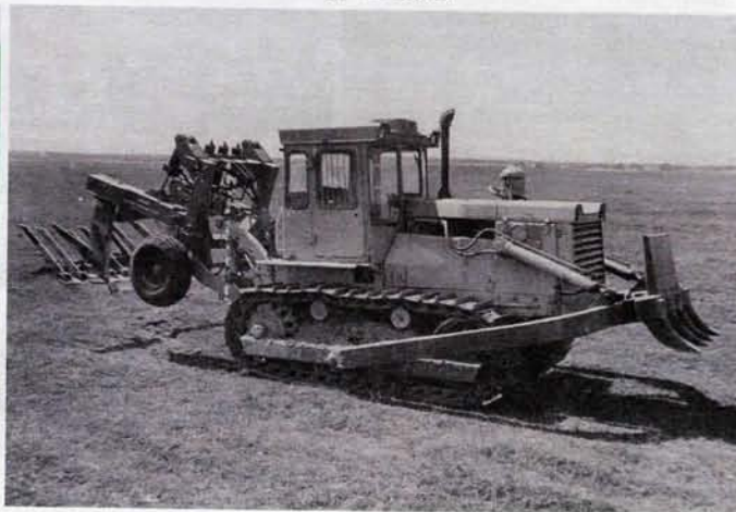
МИК-2,5 разработали в конце 1980-х, машина могла извлекать из почвы камни весом до полтонны
